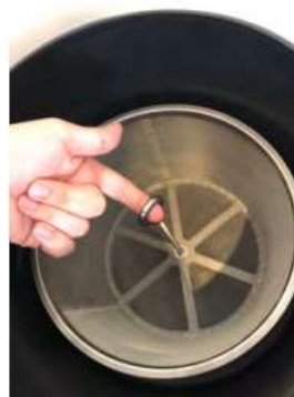
4. ábra: szűrő kiemelése a szűrőházból
